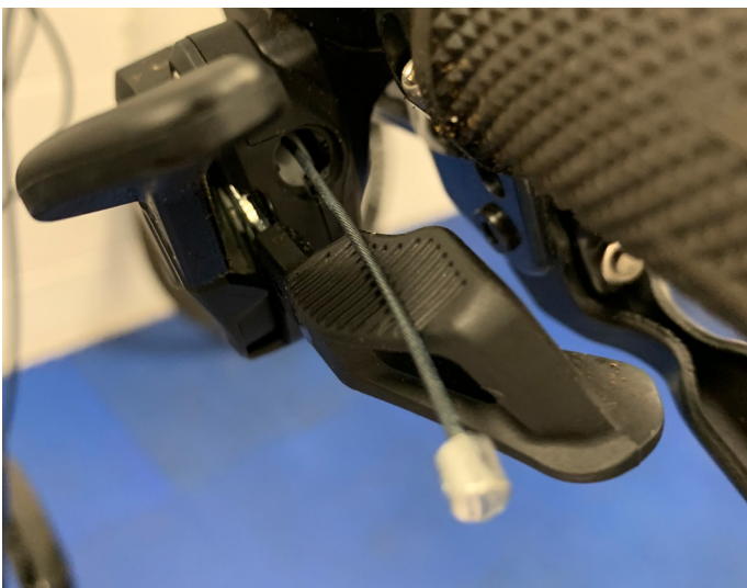
15. Remove cable via shifter
