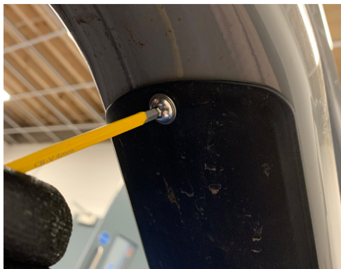
2. Remove battery door top bolt
