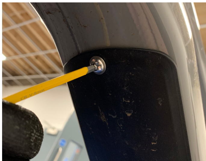
2. Remove battery door top bolt
