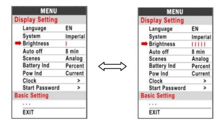
**Arrêt automatique**: Appuyer sur le bouton HAUT/BAS pour changer le moment de l'arrêt automatique; de 1 à 9, le nombre représente le temps (minutes) pour l'arrêt, la valeur par défaut étant de 5 minutes.
