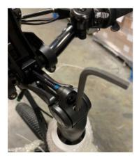
7. Faites pivoter et ajustez la barre de poignée à un angle confortable, puis serrez le long boulon sur la tige pour fixer la barre de poignée. Serrez fermement les deux boulons latéraux sur la tige, assurez-vous qu'il n'y a pas de jeu dans l'ensemble de l'assemblage.
