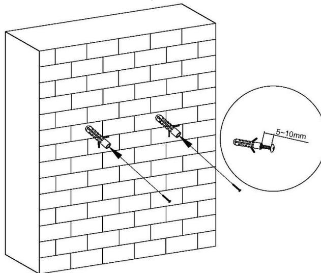
3) Posizionare la cappa aspirante sulle due viti e bloccare saldamente le viti;
