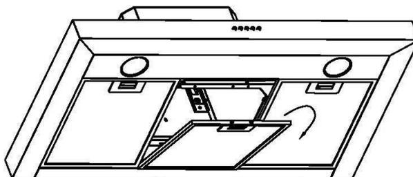
2. Spingere manualmente il portalampana LED fuori dall'armadio, estrarre la lampada LED e il cavo insieme, aprire il coperchio di protezione dell'alimentazione, estrarre la spina e sostituire la lampada LED del modello corrispondente.
