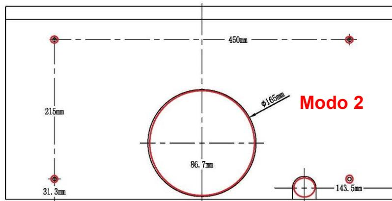
2) Allineare la porta di ventilazione dell'aria della cappa con il foro di ventilazione del mobile nella parte inferiore, far passare il cavo di alimentazione attraverso il foro di alimentazione, quindi utilizzare quattro viti da 4 \* 30 mm per bloccarlo nella posizione corrispondente della matita contrassegnata nel mobile per riparare la cappa.
