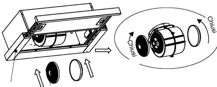
3. In caso di sostituzione, ruotarlo in senso antiorario.
