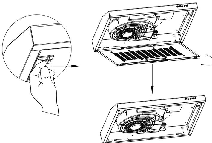
2. Allentare le viti della scatola di controllo del circuito, rimuovere il coperchio della scatola di controllo del circuito e scollegare la luce LED. Premere la fibbia della luce LED dal retro del LED per estrarre la luce.
