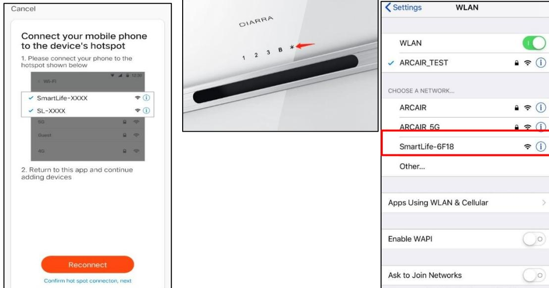
7. Después de hacer clic en "Reconnect", mantenga presionado el botón de luz de marcación en la interfaz de pantalla de la campana extractora. La luz parpadeará durante 2 minutos en el proceso de marcación. Si la marcación se realiza con éxito, aparecerá "smartlife-xxxx" en la configuración de WiFi del teléfono móvil.
