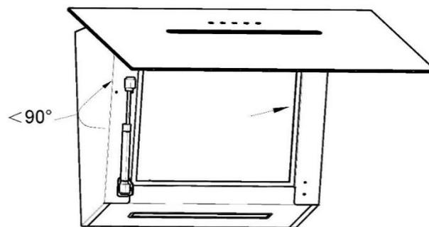
2. Enchufe el filtro de carbón activado en el soplador como se muestra y gírelo en sentido antihorario.
