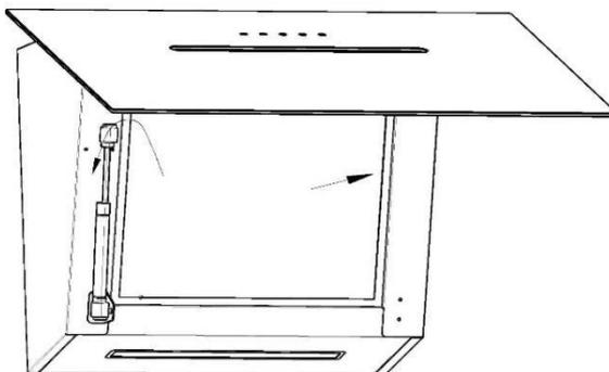
2. Empuje el portalámparas LED hacia afuera del gabinete con la mano, jale la lámpara LED y el cable juntos, abra la cubierta protectora de energía, saque el enchufe y reemplace la lámpara LED del modelo correspondiente.
