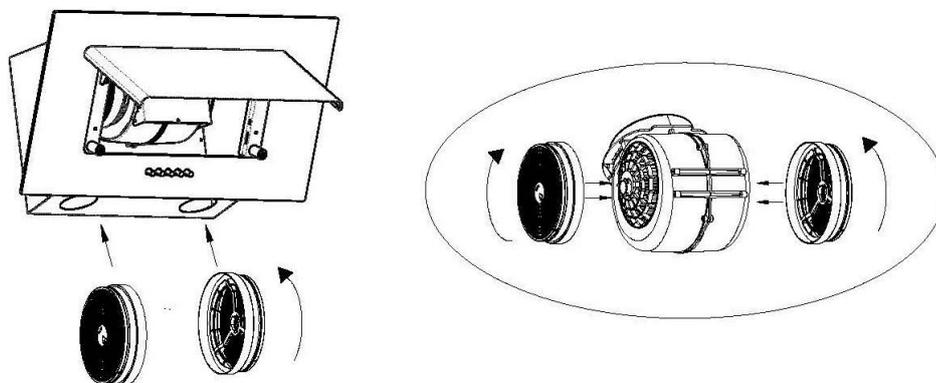
3. Installare il filtro antigrasso. In caso di sostituzione, ruotarlo in senso antiorario.
