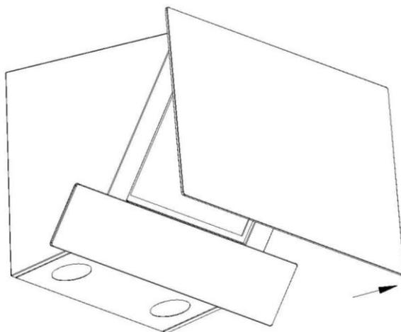
2. Spingere manualmente il portalampada LED fuori dall'armadio, estrarre la lampada LED e il cavo insieme, aprire il coperchio di protezione dell'alimentazione, estrarre la spina e sostituire la lampada LED del modello corrispondente.
