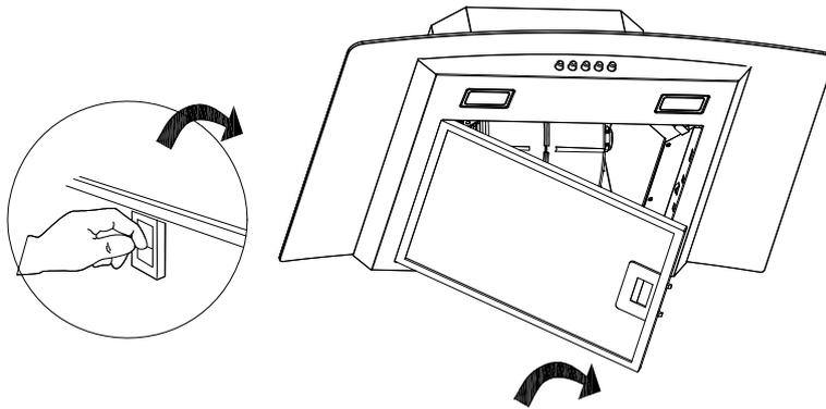
2. Posizionare il filtro a carbone nell'unità e ruotarlo in senso orario per bloccarlo in posizione.
