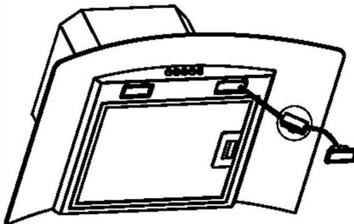
5. Installare la lampada a LED sul foro della lampada del pannello.
