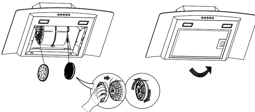
3. Se è necessario sostituire il filtro a carbone, ruotarlo in senso antiorario.
