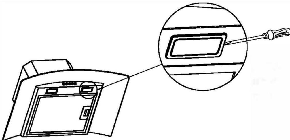
2. Estrarre la lampada a LED e il filo, aprire il coperchio del connettore del terminale della linea della lampada ed estrarre il terminale di connessione.
