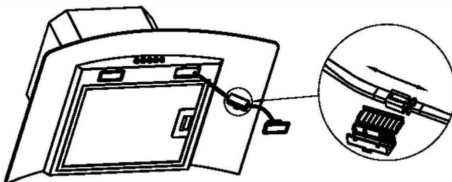
3. Collegare la nuova lampada a LED con il terminale della linea della lampada e installare il coperchio del connettore della linea della lampada.
