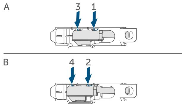
Klicken Sie den Adapter zuerst auf der linken Seite in die dafür vorgesehene Öffnung des Gaszählers ein und schwenken Sie ihn rechts nach oben.
