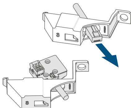
Plaats de elektronische eenheid van de ES-GAS-2 (G) met de geleidingsrails precies in de geleidingsrails van de adapter:
