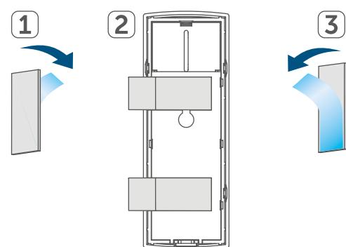
Appuyez sur l'arrière de l'appareil pour l'installer à la position souhaitée.
