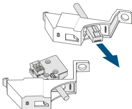
Setzen Sie die Elektronikeinheit des ES-GAS-2 (G) mit den Führungsrippen passgenau in die Führungsschienen des Adapters ein:
