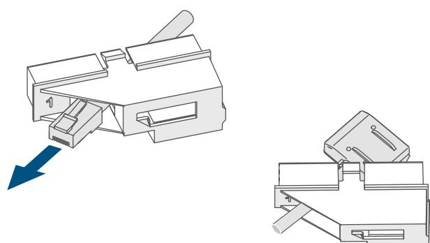
Inserte con precisión la unidad electrónica del ES-GAS-2 (G) con las nervaduras guía en los carriles guía del adaptador:
