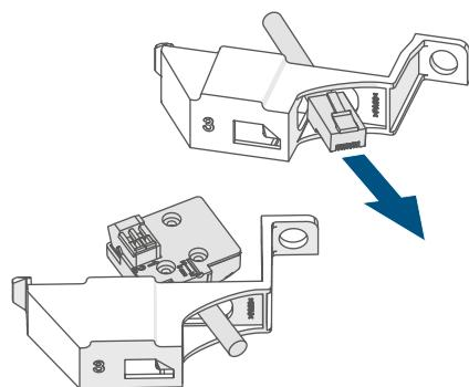
Disporre l'unità elettronica dell'ES-GAS-2 (G) con le scanalature di guida con precisione nelle rotaie di guida dell'adattatore:
