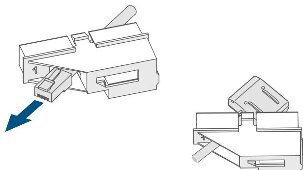
Disporre l'unità elettronica dell'ES-GAS-2 (G) con le scanalature di guida con precisione nelle rotaie di guida dell'adattatore:
