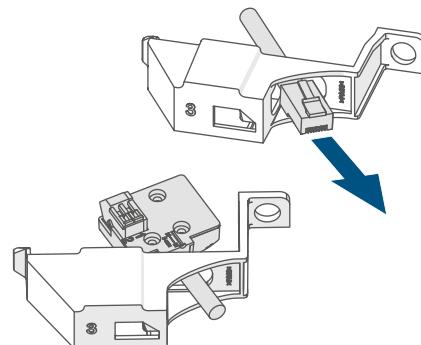
Inserte con precisión la unidad electrónica del ES-GAS-2 (G) con las nervaduras guía en los carriles guía del adaptador:
