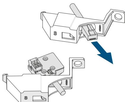
Insérez avec précision le module électronique du ES-GAS-2 (G) avec les nervures de guidage dans les rails de guidage de l'adaptateur :
