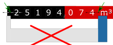
Zu tief installiert
