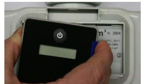
Ablösen mit Drehbewegung
