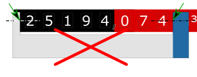
Zu hoch installiert
