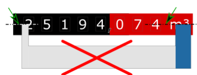
Zu weit rechts installiert
