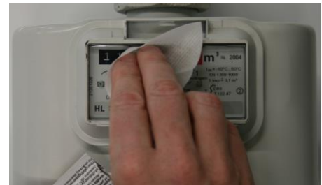
Reinigen des Zählerfensters
