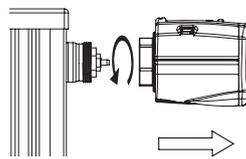
Um Sparmatic Comet zu demontieren stellen Sie auf Pos. **EIN**, drehen Sie hierzu am Drehrad über die höchste Temperatur von 28°C hinaus bis **EIN** im Display erscheint.
