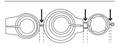
Die markierten Verbindungsstäbe bitte vor der Montage der Adapter komplett entfernen! Weitere kostenpflichtige Messing-Adapter-typen finden Sie unter: [www.eurotronic.org/produkte/zubehoer/metalladapter](http://www.eurotronic.org/produkte/zubehoer/metalladapter)
