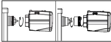
1. Alten Thermostatkopf ganz aufdrehen, Befestigung lösen und vom Ventil abziehen.
