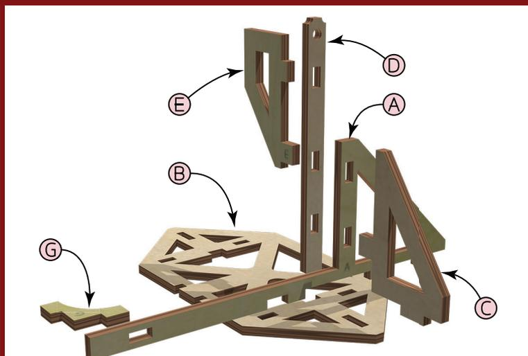
**2** Collez un renfort d'angle (G), un renfort de portique extérieur (C) et un montant de portique (D) sur un cadre latéral (A). Collez le cadre latéral sur la base (B) et le support de portique intérieur (E) sur le cadre
