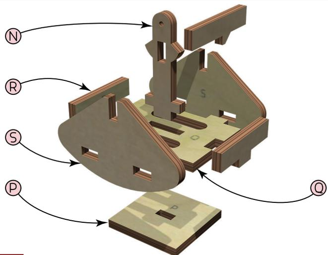
**6** Collez la barre de contrepois (N) sur la plaque de base (P) et le sol (Q). Collez les cadres d'extrémité (R) et la barre transversale (T) en place. Collez les cadres latéraux (S) sur l'assemblage.
