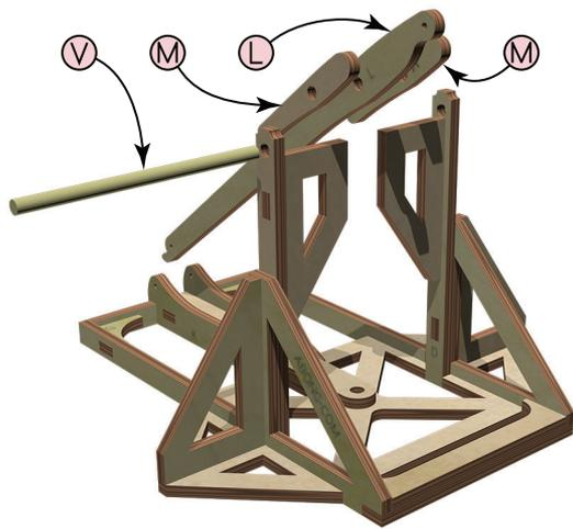
**5** Collez les pièces de joue (M) sur le bras de lancement (L), en vous assurant que les trous sont alignés. Faites glisser l'essieu (V) à travers les montants et le bras de lancement. Collez l'essieu sur les renforts du portique.
