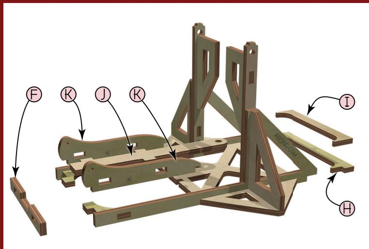
**4** Assemblez les pièces du cadre avant (H, I) et collez-le en place. Collez le cadre d'extrémité (F) aux renforts d'angle. Assemblez l'auge à l'aide des deux côtés (K) et d'un fond (J). Collez l'auge à la base et au cadre.
