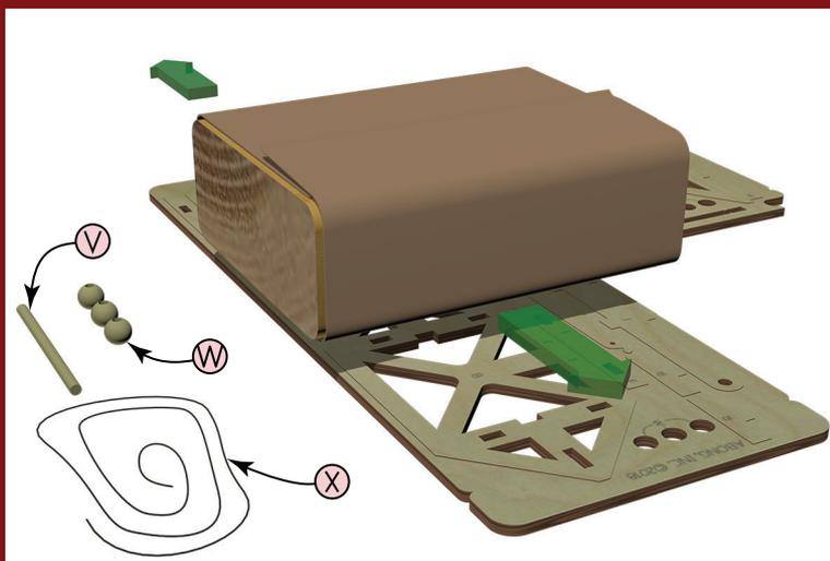
**1** Retirez et mettez de côté l'essieu (V), les munitions (W) et le cordon (X). Poncez d'abord les deux côtés des planches de support avec du papier de verre grain 150, puis 220.
