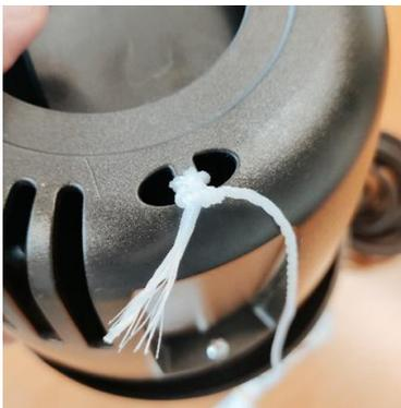
Befestigen Sie beide Nylonseile an den Löchern unten an der Pumpe
