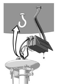
Agganciare la lampada al soffitto, aprire la scatola contenente il morsetto (9) ed effettuare i collegamenti elettrici rispettando le posizioni dei cavi. Una volta completati i collegamenti, richiudere la scatola contenente il morsetto (9).
