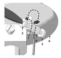
Infilare l'estremità opposta dei cavi di sospensione in uno dei due fori del morsetto (4), farla passare nei due fori presenti sul supporto (8) e,-infine, nel secondo foro del morsetto (4). Stabilire la distanza tra il diffusore (5) e il soffitto, regolare di conseguenza la lunghezza dei cavi di sospensione e stringere le viti (3) del morsetto (4).
