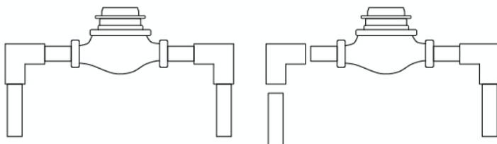
2.- Sustituir el codo por una Tee
