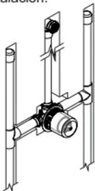
**Nota:** Asegúrese de que el acabado final se instalará dentro del Rango de Instalación (RI).
