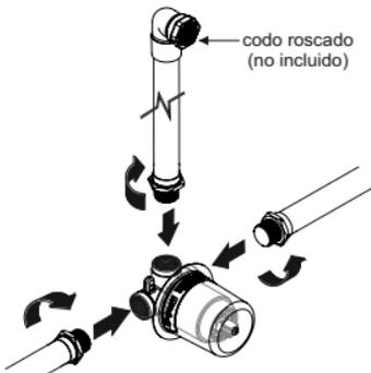
5. Inserte la válvula con portacartucho dentro del ranurado de la pared, nivele y fije la instalación.
