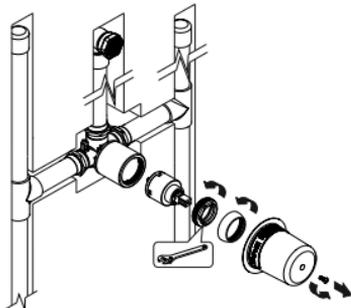
7. Mantenga hermética la instalación y genere una prueba de fuga a la presión de operación (0,8 - 6 kg/cm<sup>2</sup>).
