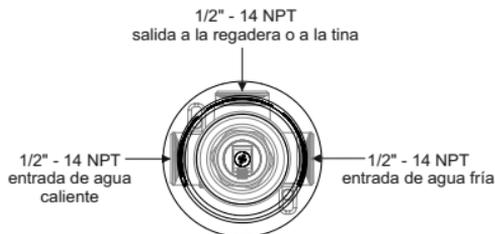
Coloque teflón en las conexiones roscadas.
