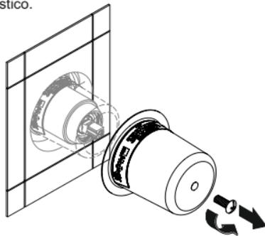
9. Inserte el chapetón y el maneral, posteriormente enrosque el opresor con la llave allen (incluida) para fijar.
