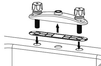
Por debajo de la mezcladora coloque la Tapa de la Cubierta (10) cuidando que la parte lisa de la Tapa quede orientada hacia abajo e inserte la mezcladora en los orificios correspondientes de la Tarja.
