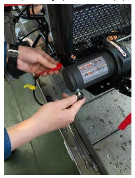
步骤五:将控制器延伸出来的主电缆,沿着车架左侧排线,直至电瓶处。
