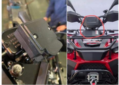
步骤七: 将绞盘控制器上的线缆, 与绞盘开关上的线缆对插 7. Connect the wire of the winch to the wire of the winch switch.(See pic)
