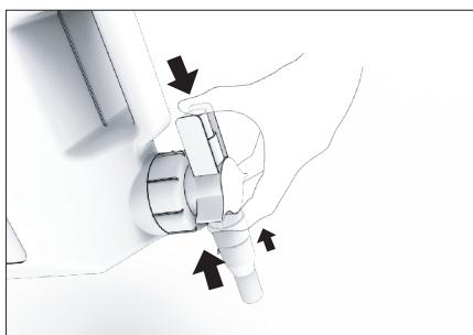
3. 燃料注入は両手で行ってください。片手の手のひらをノズル上部に、その親指は緑色のボタンに置いてください。もう片方の手で燃料缶を垂直に傾け、しっかりと押さえてください。緑色のボタンを押して、燃料を注ぎます。注入を止めるには緑色のボタンを離します。
