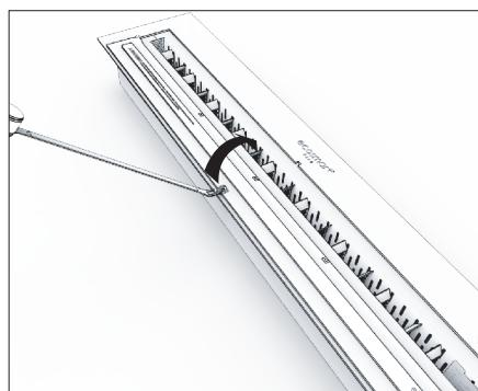
XL700/XL500: 上下式の蓋で消火する仕組みになっています。点火部分を覆う上下式の蓋で炎を消火します。
