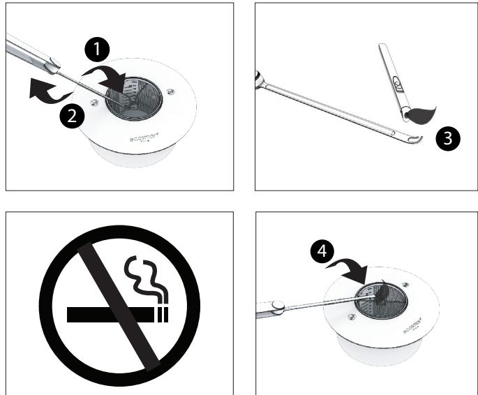
1. 蓋を開けて燃焼室に着火補助棒の先端を浸して、燃料で湿らせます。
