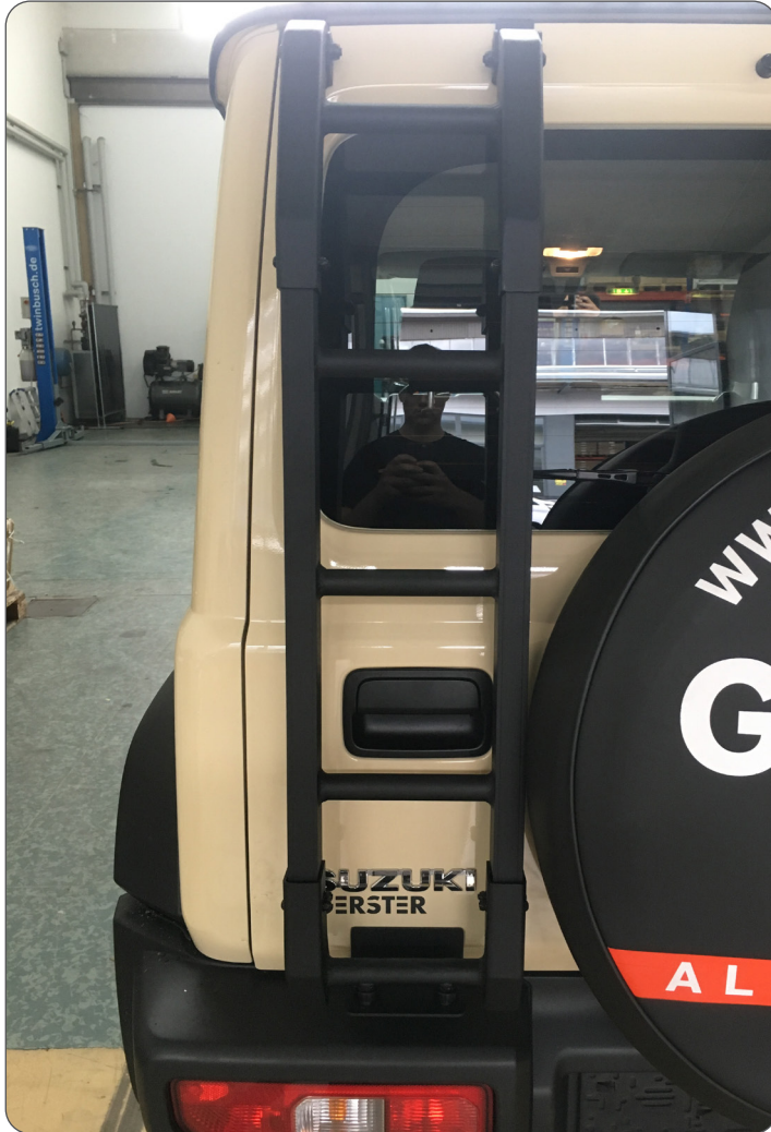
Abb. 10: Montierte Leiter / mounted ladder
