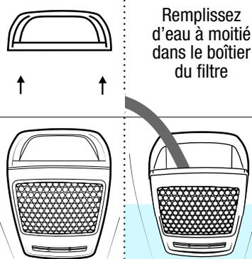
Retirez les vis et remplissez le spa avec de l'eau à travers le boîtier du filtre
