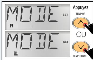
Appuyez sur le bouton "TEMP UP" ou "TEMP DOWN" pour sélectionner le mode prêt R ou de repos puis appuyez à nouveau sur le "MENU" pour terminer l'action. **Remarque: il est recommandé de laisser le spa en mode prêt (R)**
