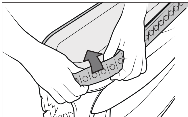
Figura 26. Retire la oruga anterior
