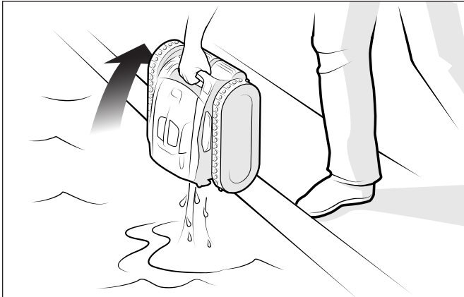
Figure 10. Garder le nettoyeur vertical pour drainer l'eau
