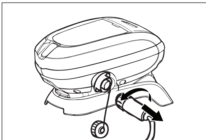
Figure 18. Débrancher le câble flottant
