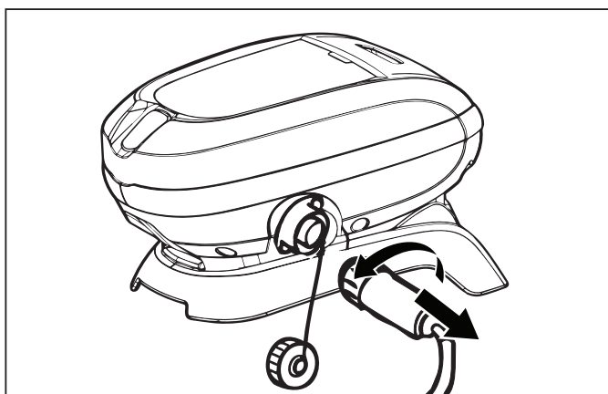
Figure 18. Desenchufar el cable flotante
