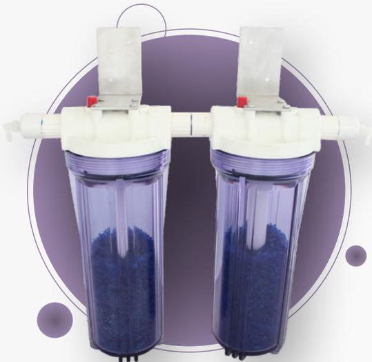
**Sistema de vasos transparentes con gel sílica para retención de humedad.** Permite vida prolongada al reactor de ozono al tener aire seco como fuente de alimentación para generar ozono. Cambia de color con la humedad y se puede regenerar. Se sugiere en zonas con <60% HR **(solo modelo WHE)**.
