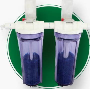
**Sistema de vasos transparentes con gel sílica para retención de humedad. (Incluidos en la compra del equipo)** Permite vida prolongada al reactor de ozono al tener aire seco como fuente de alimentación para generar ozono. Cambia de color con la humedad y se puede regenerar.
