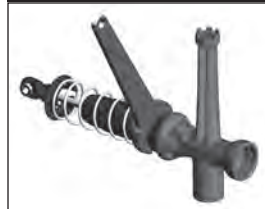
A. Tighten/Loosen Upper Cap
