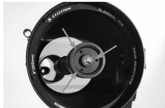
Einstellschrauben für die sekundäre Spiegelkollimation
