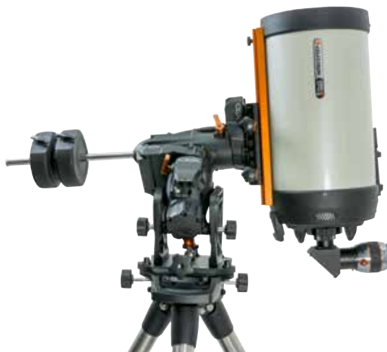
Figure 6 Équilibrage de la monture
