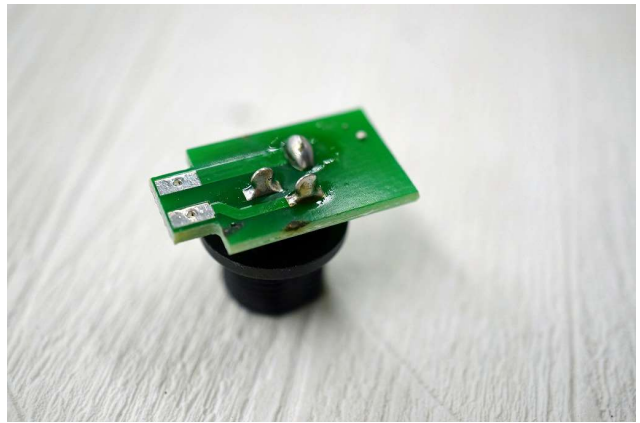
DC ジャックも同様に3つの端子をはんだ付けします。
