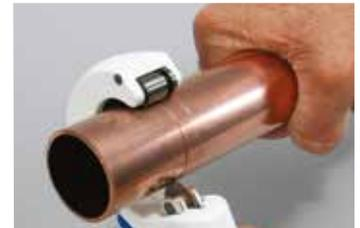
Der Multi 67 Rohrabschneider kann für Kunststoff- und Verbundrohre bis zu 67 mm Rohrdicke sowie Kupfer- und Edelstahlrohre verwendet werden.
