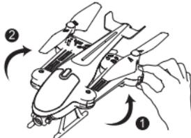
2. Klappen Sie die Arme in Pfeilrichtung ein, bis der Quadcopter vollständig eingeklappt ist.
