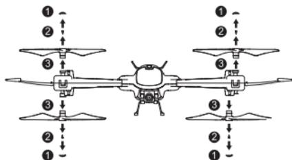
Entfernen Sie die Propellerabdeckungen und Schrauben in Pfeilrichtung,
