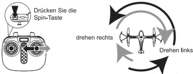
Drücken Sie die Drehtaste oben links an der Fernbedienung, während Sie den rechten Joystick nach links oder rechts halten. Die Drohne dreht sich entsprechend nach links oder rechts.
