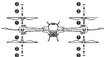
Stecken Sie die Propeller in Pfeilrichtung auf den Körper des Quadcopters, and then tighten the screws and attach the propeller covers.
