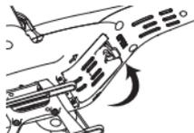
Legen Sie die Batterie ein und schließen Sie den Batteriefachdeckel.
