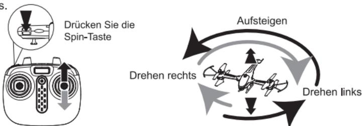
Drücken Sie die Drehtaste oben links an der Fernbedienung und bewegen Sie den rechten Joystick nach oben oder unten. Die Drohne dreht sich im Kreis und steigt ca. 60-90 cm auf.
