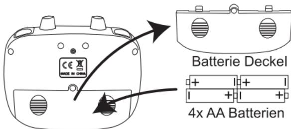
Zum Einlegen der Steuerungsbatterien öffnen Sie den Batteriefachdeckel auf der Rückseite der Fernbedienung und legen Sie 4x AA-Alkalibatterien ein, wobei Sie auf die Polaritätsmarkierungen achten müssen (Batterien sind nicht im Lieferumfang enthalten und müssen separat erworben werden).
