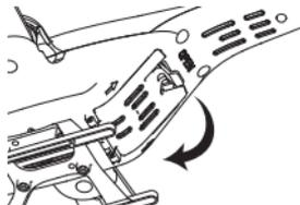
Öffnen Sie den Batteriefachdeckel und nehmen Sie die Batterie heraus
