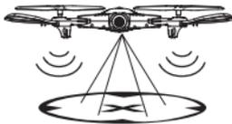
Wenn der Drohn eingeschaltet ist, startet der Drohn automatisch die Positionierungsfunktion mit dem optischen Fluss, wenn sie in der Luft schwebt, und der Drohn bleibt an einem bestimmten Punkt stationär.
