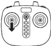
Drücken Sie den linken Joystick (Gashebel) auf die niedrigste Stufe und halten Sie ihn 2 bis 3 Sekunden lang. Der Drohn kann dann ausgeschaltet werden.
