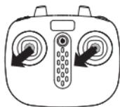
Wenn der Drohn im kopflosen Modus direkt an einem direkten Gegenstand gestoßen hat und eine Abweichung von der definierten Richtung auftritt, nachdem die Flugrichtung in die richtige Position gesetzt wird, sind der linke und der rechte Joystick gleichzeitig in die unteren linken Ecken gedrückt zu werden. Wenn sich die LED-Leuchtanzeige des Drohnes 3 Sekunden langsam blinkt und dann dauerhaft leuchtet, d.h. dass die Kalibrierung abgeschlossen ist.
