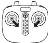
Schieben Sie den linken und rechten Joystick für 1 Sekunde lang in die unteren inneren Ecken. Die Blätter des Drohnes beginnen langsam zu drehen.
