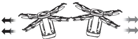
Wenn die Drohne im Schwebeflug nach links oder rechts driftet, halten Sie den linken Joystick gedrückt und drücken Sie den rechten Joystick nach rechts/links, bis die Drohne nicht mehr driftet.
