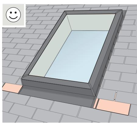
**FRANÇAIS:** Pour une meilleure apparence, les coins de solin d'appui et de solin en sabot exposés peuvent être recouverts d'un bardage de finition.
