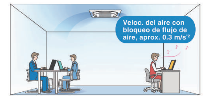
La función de bloqueo de flujo de aire previene las corrientes molestas al reducir la velocidad del aire en aprox. 0.3 m/s. 2
