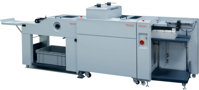
Dans la RD-4055, le papier est alimenté à partir de la pile d'entrée de 50 cm. Les feuilles passent par une table enregistreuse à commande électronique de haute précision et sont placées entre le rouleau à plaque magnétique et le rouleau à contre-pression où elles sont découpées. L'imprimé découpé est ensuite séparé des feuilles dans l'unité de séparation et le produit fini est placé sur la table de sortie, prêt à être emballé.
