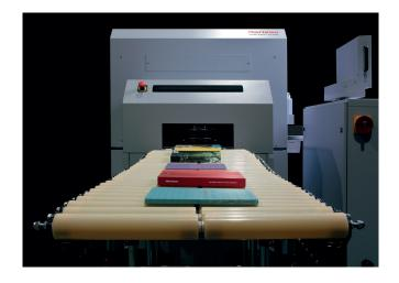
Les livres collés sont soigneusement transférés sur un tapis roulant pour le séchage et transférés au HT-1000V. Le massicot trilatéral entièrement automatique se règle sur la base d'un code à barres, après quoi les livres sont parfaitement rognés des trois côtés.
