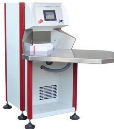
Papiertelmachine voor zware grammages tot +250gr
