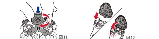
※分解し、掃除する際は内刃と外刃の組み合わせを変えないようにご注意ください。組み合わせが変わると、刃の組み合わせの状態が元通りになるまで数週間かかる場合があります。
