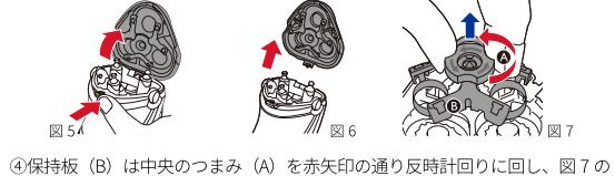
④保持板 (B) は中央のつまみ (A) を赤矢印の通り反時計回りに回し、図 7 のように、青矢印の方向に持ち上げると外れます。
