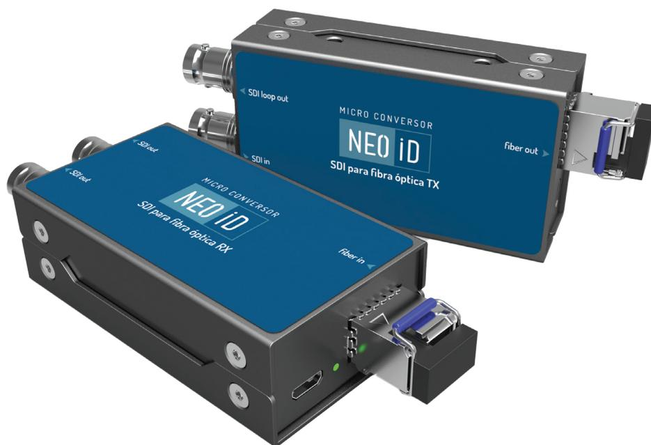
O Conversor NEOiD SDI para Fibra é um kit transmissor e receptor que suporta extensões de fibra LC simplex monomodo de até 20km. É uma solução de extensão compacta que oferece suporte a todos os formatos SDI de resolução de até 1080p com áudio e metadados, também oferece suporte a nível A e nível B. Possui uma saída de loop SDI local e duas saídas SDI e suporta sinais SDI 3G / HD / SD .
