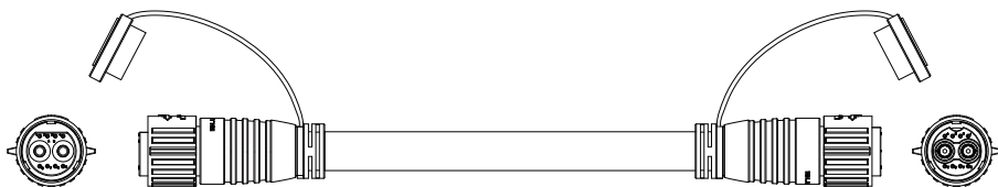
図7-1バッテリーパック接続ケーブル
