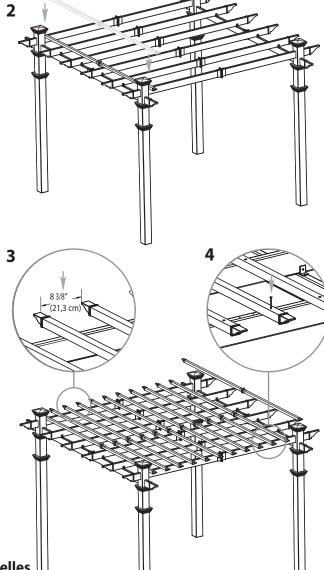
Si l'ensemble de lamelles d'ombrages additionnelles est installé rétroactivement, placez tout simplement une lamelle d'ombrage entre deux lamelles d'ombrage pré-existantes. Seulement 11 lamelles d'ombrage addditionnelles seront utilisées dans ce cas.
