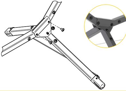
Unten das äußere Verbindungsblech montieren (auf beiden Seiten) und je eine Schraube an der Position eindrehen.
