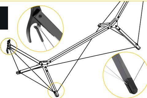
Das Stahlseil durch die Standfüße führen. Darauf achten, dass das Stahlseil nicht verdreht wird. Das Seil dann oben an beiden Enden des Schrägrohrs einhängen.
