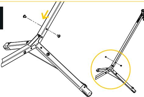
Das Schrägrohr beidseits aufstecken.
