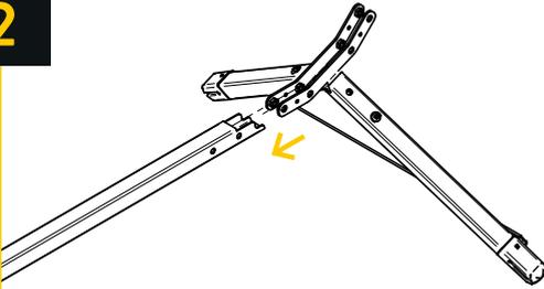
Das Vertikalrohr vorne und hinten an beiden Standfüßen aufstecken.
