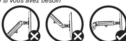
Si le bras tombe, tournez la vis de réglage dans le sens inverse des aiguilles d'une montre jusqu'à ce qu'il reste en position horizontale.
