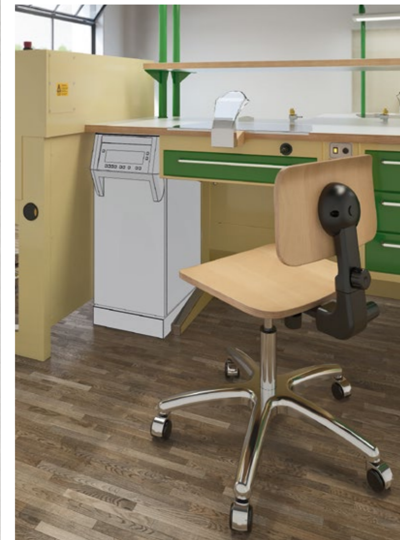
Verbindungsbeispiel mit Absaugungsanlage ausgestattet mit automatischer Anlauf.
