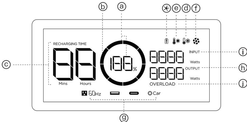
a. バッテリー残量表示 - バッテリー残量を表示します。バッテリーの残量が0%になると、画面上のバッテリー表示が点滅し始めますので、速やかに充電してください。
