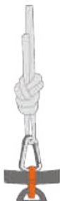
Fig. 13 : Deux mousquetons de verrouillage à rotation opposée dans un anneau de serrage
