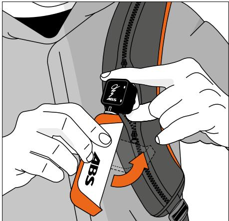
La poignée de déclenchement se range dans la bretelle et doit rester solidement fixée au sac à dos. Ouvrez la fermeture éclair de la bretelle. Basculez la poignée de la position verticale OFF vers la position horizontale ON pour activer le système.
