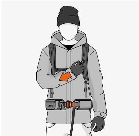
La force de déclenchement requise est d'environ 6 kg (60 N). Les airbags ne se gonfle pas ; seule la force de traction est simulée. Si l'exercice de déclenchement est réussi, la LED supérieure s'allume en blanc pendant 3 secondes et clignote ensuite à nouveau en rouge.
