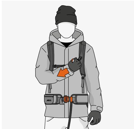
La forza necessaria è di circa 6 kg (60 N). Gli airbag non si gonfiano, viene soltanto simulata la forza di trazione. Se l'attivazione di prova riesce, il LED in alto diventa bianco per 3 secondi e poi diventa rosso lampeggiante.
