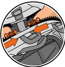
Ouvrez entièrement la fermeture éclair du compartiment à airbag de sorte que le curseur ne se déplace que d'un seul côté. Ramenez le curseur entièrement vers le haut et reliez les extrémités de la fermeture éclair.
