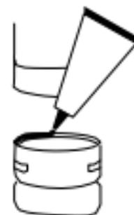
**Exigence:** Le tuyau utilisé doit être de type « L » ou « PL » d'un diamètre de 3 po ou 4 po. Fixez un adaptateur de 3 po à l'orifice d'échappement au moyen d'un scellant haute température (tel que du silicone RTV).
