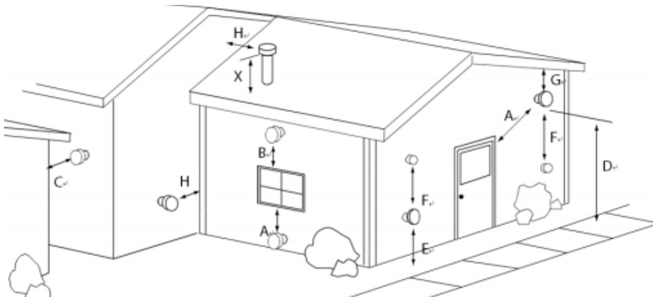
A : dégagement minimal de 48 po sous toute porte ou fenêtre qui peut s'ouvrir, ou à côté de celle-ci. (Ce dégagement peut être réduit à 18 po si vous utilisez l'air extérieur.) Nous vous recommandons de maintenir la porte ou la fenêtre fermée pendant le fonctionnement du poêle. Dégagement minimal de 12 po sous toute porte ou fenêtre qui ne peut pas s'ouvrir, ou à côté de celle-ci.
