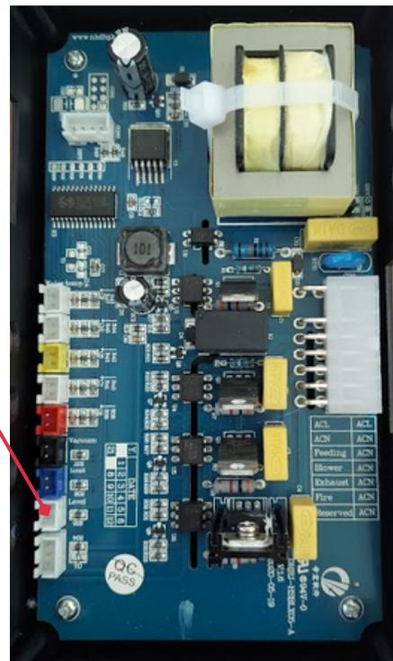
**Connexion d'un thermostat** : Connectez les fils d'extension "Appel de chaleur" du thermostat à la carte de circuit imprimé inférieure.
