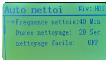
1. « Fréquence nettoie » : contrôle l'intervalle de temps entre chaque cycle de nettoyage (en minutes).
