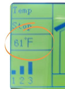
*REMARQUE : en mode « Temp », le poêle ne s'arrête pas et ne passe pas au mode veille. Il fonctionne simplement au ralenti et continue de produire du feu jusqu'à ce que la température de la pièce passe sous la température « Call to » réglée. Au ralenti, le niveau de puissance de chaleur est indiqué par un « 1 » à l'écran. Pour permettre au poêle d'automatiquement se mettre en marche et de s'arrêter alternativement, sélectionnez l'option ECO (consultez la section « Réglages »).*
