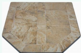
Le poêle doit être installé sur un plancher non combustible doté d'une protection adéquate, ou encore sur unâtre de maçonnerie. Si un événement en « T » de nettoyage est installé à l'intérieur du bâtiment, le protecteur de plancher doit s'étendre 2 po au-delà de l'arrière de cet événement. Si le poêle s'évante dans le mur et l'événement en « T » se situe à l'extérieur du bâtiment, le dégagement minimal est de 2 po de l'arrière du poêle jusqu'au mur
