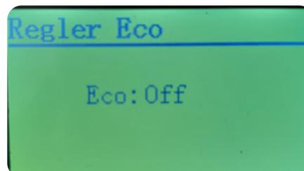
Lorsque la fonction ECO est à « ON » et le poêle fonctionne en mode « Temp », le poêle affiche le message « Fire off » et s'arrête lorsque la température réelle (dans la maison) atteint ou excède la température désirée ou « Call to » (à gauche de l'écran). Lorsque la cage d'évacuation est refroidie et la température chute sous la température désirée, le poêle se rallume automatiquement. Ce cycle marche-arrêt se poursuit jusqu'à ce qu'il soit interrompu ou annulé.
