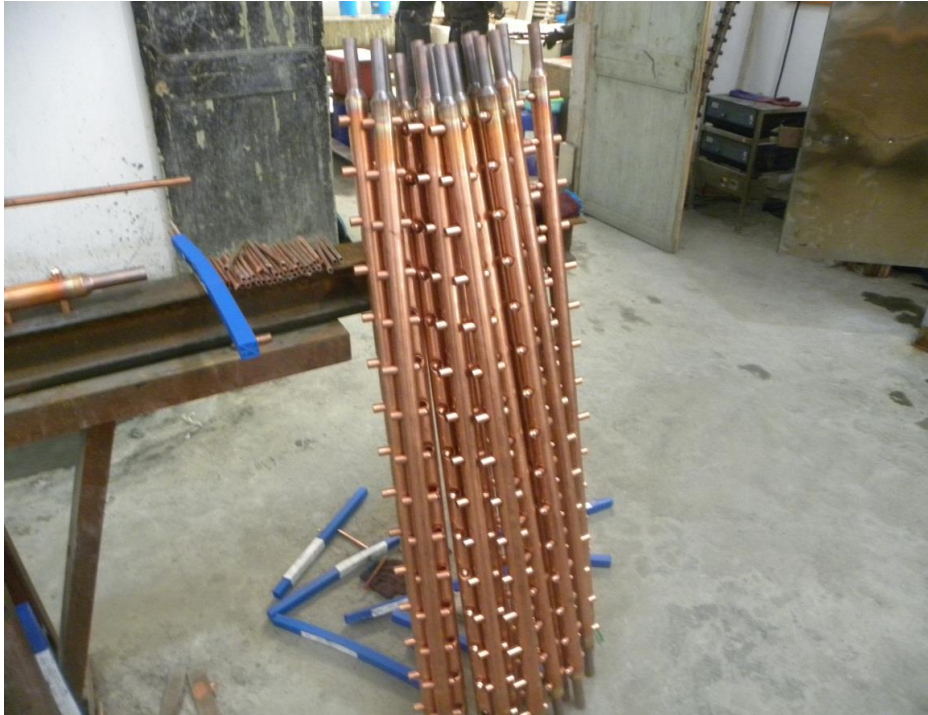
( Collecteur-Manifold Main Pipe)
