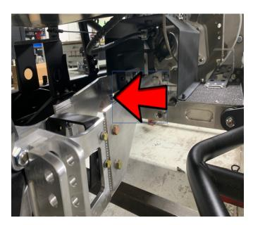
\*\*\*CHECK TORQUE ARM CLEARANCE AROUND RUBBER FLOOR BLOCK & FRAME UNDER FULL DROOP\*\*\*
